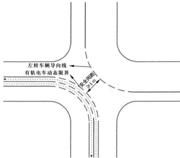
图 3 有轨电车线路转弯与对向转弯机动车辆最小安全间距示意
