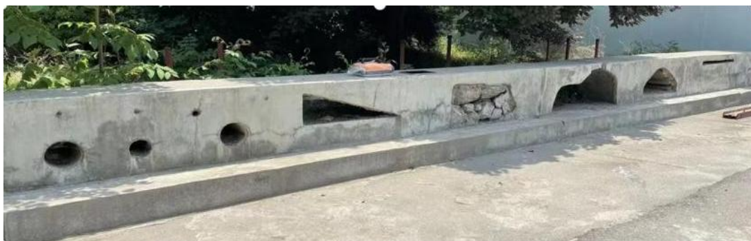
图 D. 3 混凝土试件不规则孔洞
