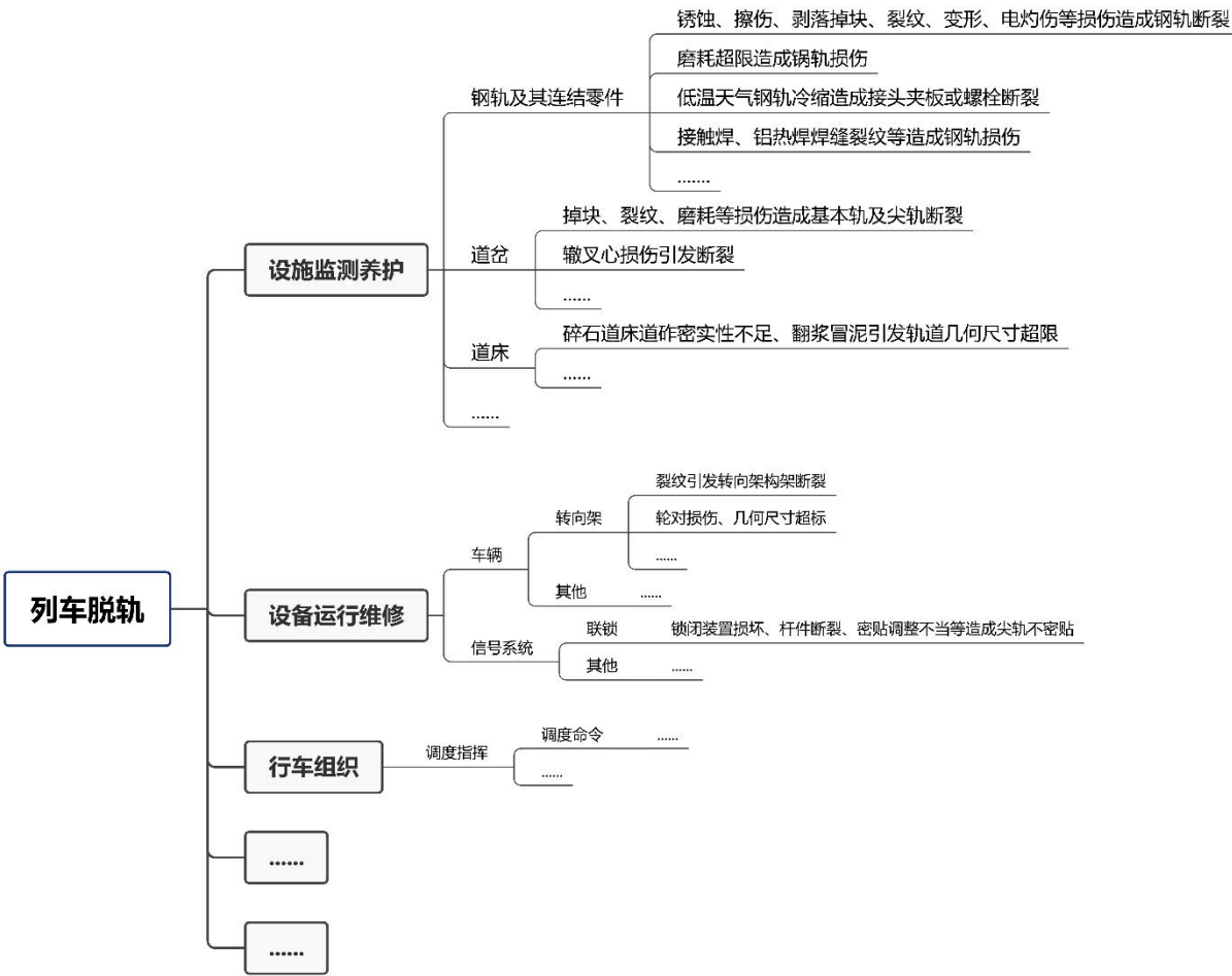
图 A. 1 列车脱轨风险图谱示例
